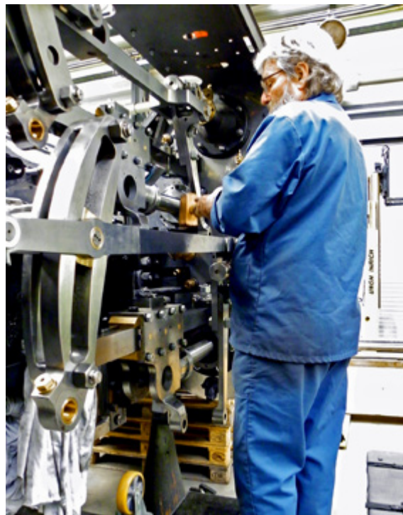
Vereinsmitglied Felix Walser beim Einpassen des Kreuzkopfkeils in die neue Steuerung der HG 4/4, 708
